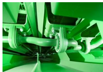
Соломотряс монтируется на шарикоподшипниках
